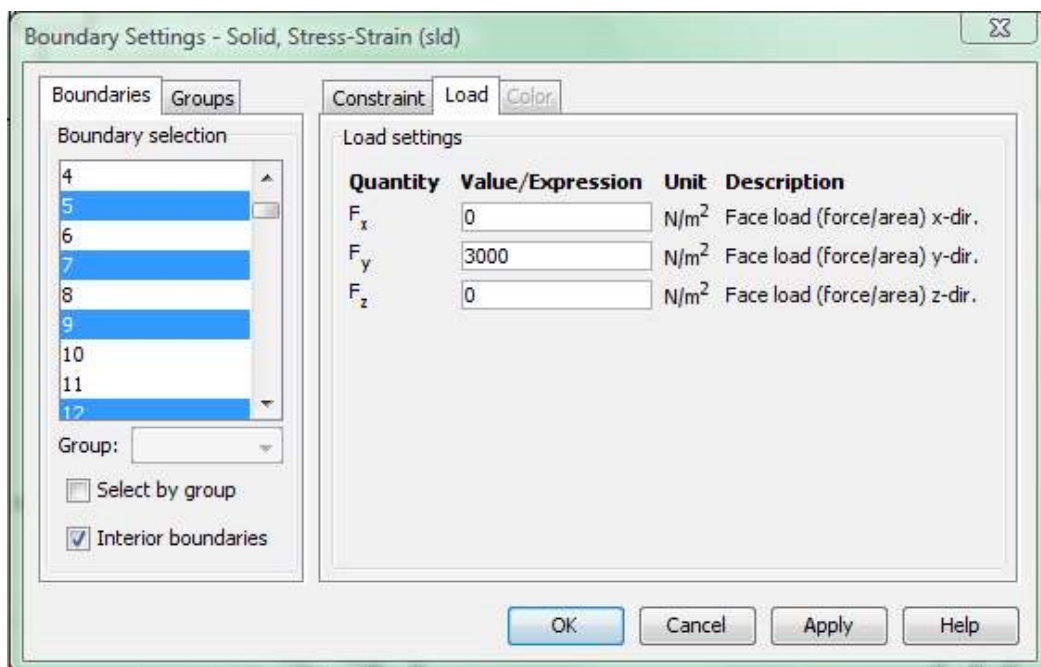
Rys. 5 Wprowadzenie warunku brzegowego dla krawędzi dodatkowego elementu
