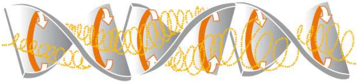
Rys. 2.7 Zasada działania mieszalnika statycznego [10].
